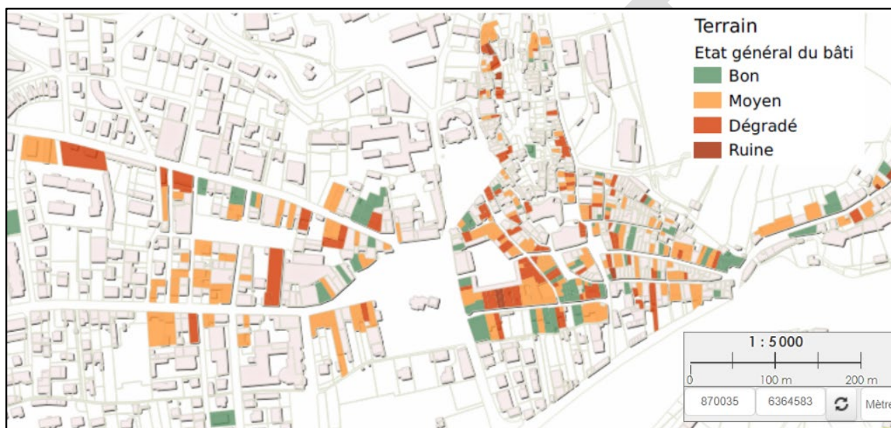
Carte du centre-ville de Nyons issue du relevé de dégradation effectué par arpentage terrain
